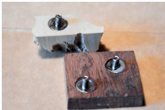
Derpå limes postskruerne på emnerne – husk at tørre overskydende lim væk.
