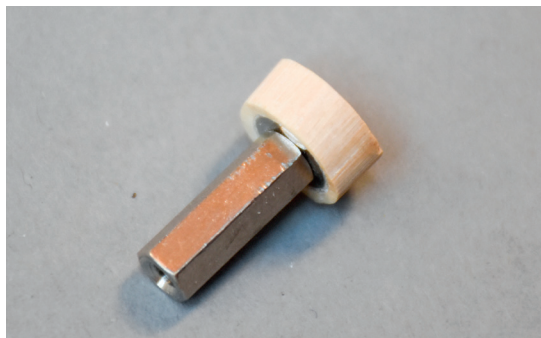
Her er et groft tilvirket emne monteret i mit lille gevindstykke, så det kan sættes i boremaskinen.
