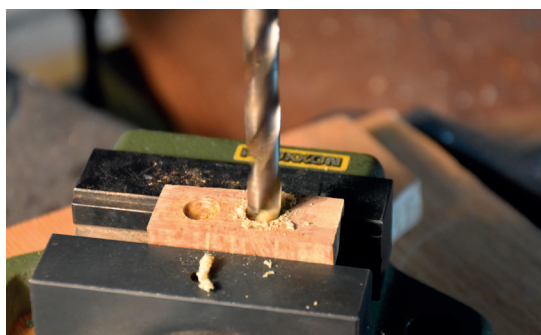
Der bores en fordybning til den ene del af postskruen.
