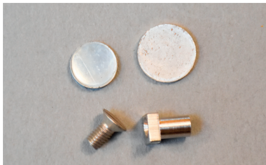
Her ses alle delene til en stropknap i sølv: 2 skiver, en skrue og et gevindstykke.
